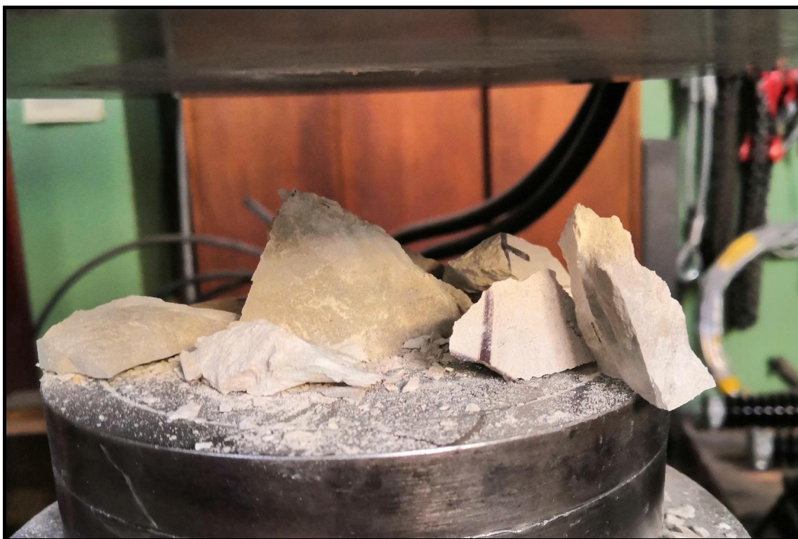
Foto 6: Zkušební těleso 3-1 (slínovec) po zkoušce
