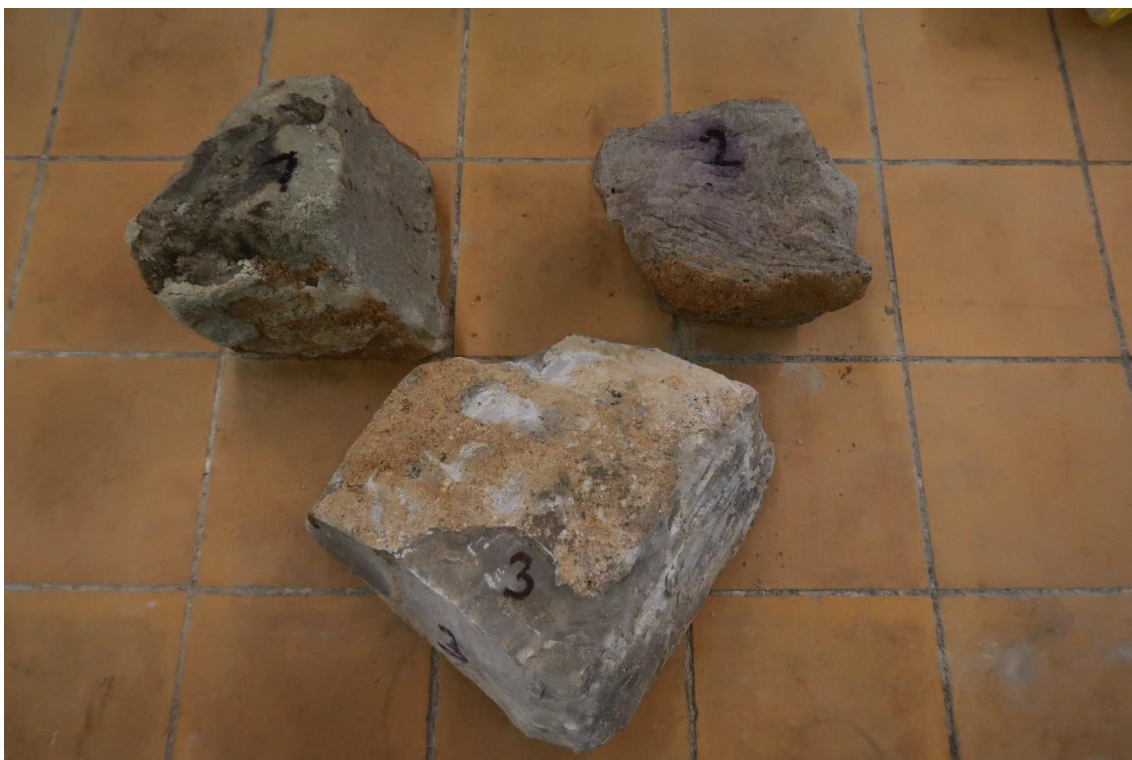
Foto 19: Pohled na odebrané vzorky 1 (pískovec), 2 (pískovec) a 3 (slínovec=opuka)
