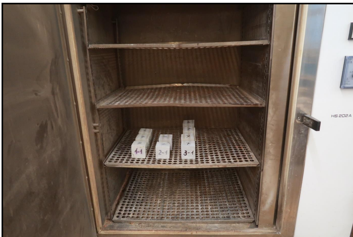
Foto 2: Zkušební tělesa v sušárně (sušení do ustálené hmotnosti)
