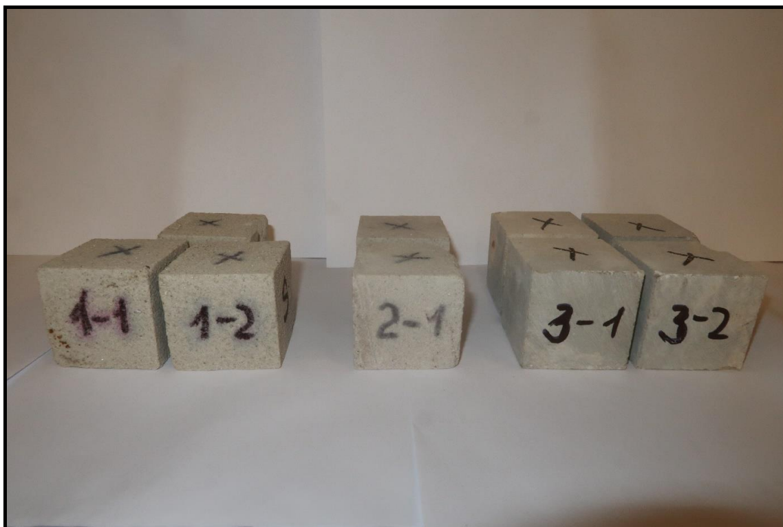
Foto 1: Pohled na všechna vyříznutá tělesa (krychle o hraně 50 mm) z odebraných vzorků (celkem 9 ks)
